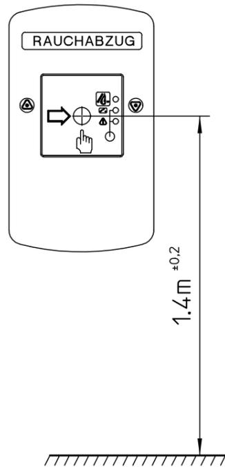
Montage: Abstand Drucktaste zum Fußboden
