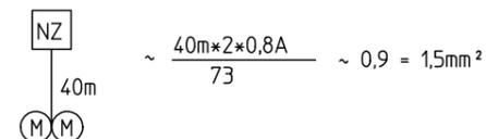
Bei Leitungsabzweigung (z.B. mehrere Leitungsstränge)
